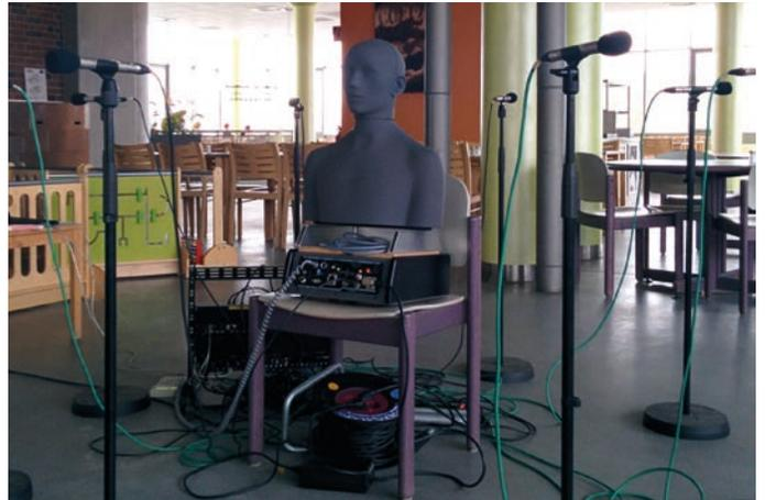
Bild 2. Mehrkanalaufnahmen zur räumlichen Reproduktion von Schallfeldern
