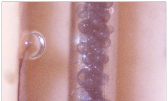
Abbildung 8. Geordnete magnetische Partikel in destilliertem Wasser im Mikrokanal (250  $\mu\text{m}$  x 50  $\mu\text{m}$ ) mit äußerem magnetisches Feld
