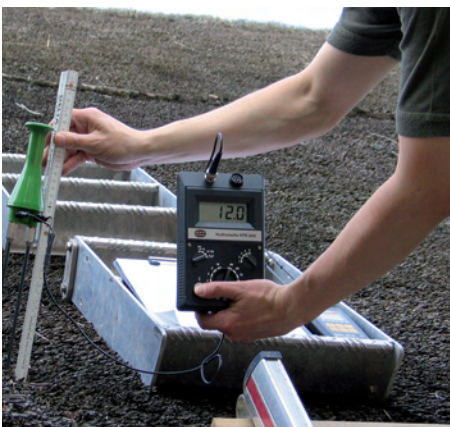
Abb. 4: Feuchtemessungen in verschiedenen Tiefen
