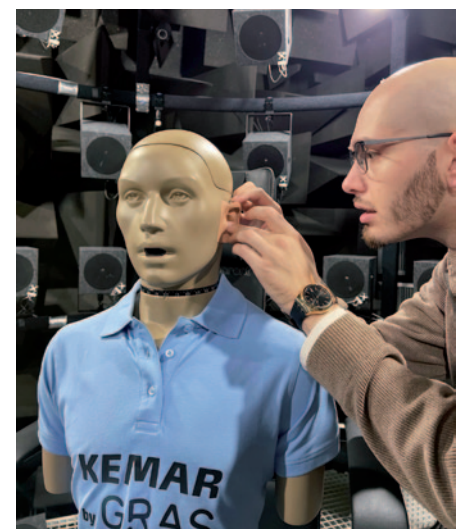
Ein Hörakustikstudent versieht einen Kunstkopf mit Hörgeräten zur technischen Vermessung.
