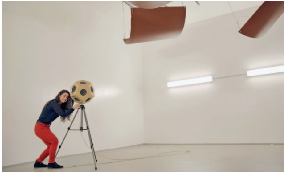
Eine Studentin bereitet eine Schallabsorptionsmessung im Hallraum vor.
