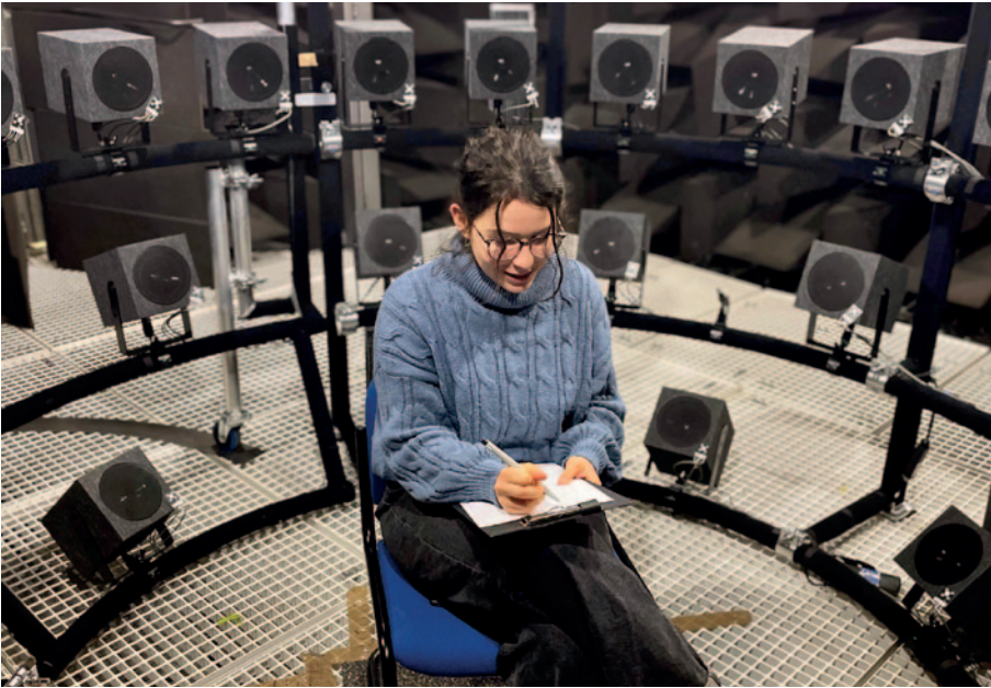
Durchführung einer psychoakustischen Studie im Multikanallautsprecher-System, installiert im reflexionsarmen Raum der TH Lübeck
