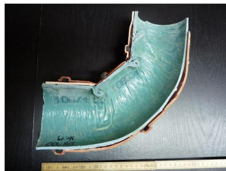
Schlauchliner DN 100 im 90° Bogen DN 100
