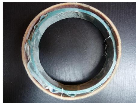
Schlauchliner DN 125 im Rohr DN 150
