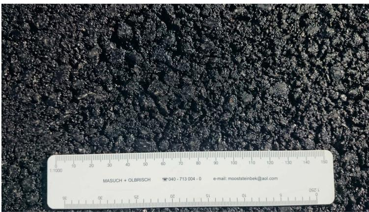
Bild 1: Mittels Rüttelplatte verdichtete Fläche
