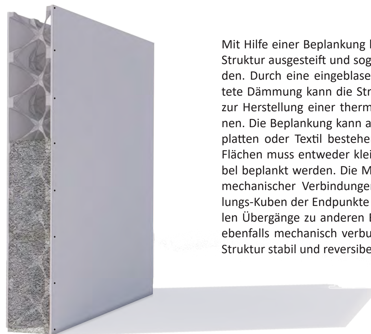
Modulare Wand mit loser Dämmung
