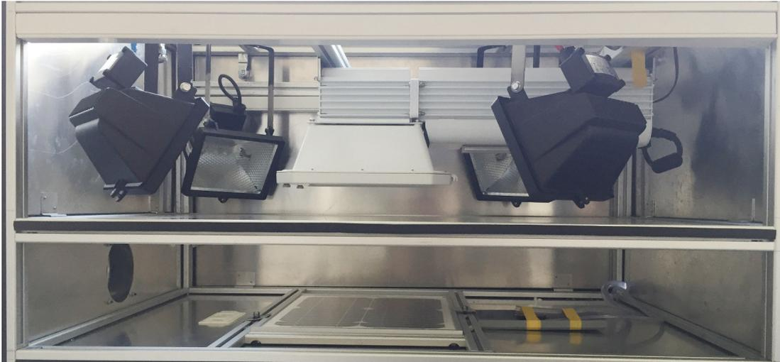
Abbildung 3.3: Lampen und PV-Modul der Sonnensimulation
