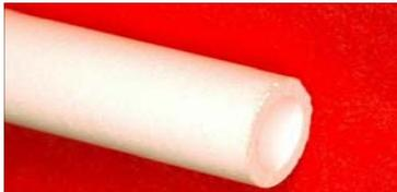
Das  $Al_2O_3$ -Röhrchen mit  $0,8 \mu m$  Porengröße hat eine Wandstärke von  $0,5 mm$ . Um die Drosselwirkung zu verstärken, ist an der Innenfläche eine Beschichtung mit Porengrößen von bis zu  $0,9 nm$  aufgebracht.
