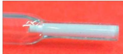
Der  $ZrO_2$ -Vollzylinder mit einer Porengröße von  $0,2 \mu m$  ist in einer Glaskapillare eingeschmolzen. Für einen variablen Flow werden mit einem Excimer-Laser Bohrungen in die Glasschicht eingebracht.
