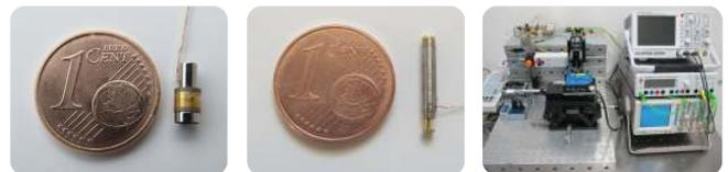
Abbildung 7: bistabiler Hohlaktuator (links), bistabiler Vollaktuator (Mitte), Prüfstand für Aktuatoren (rechts)
