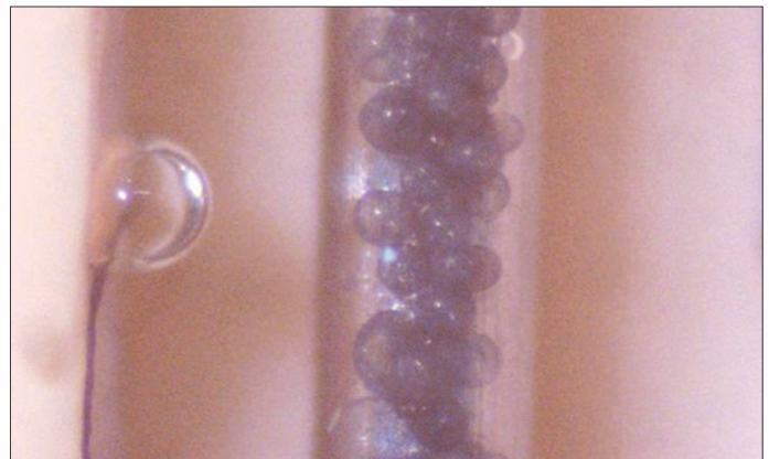
Abbildung 8. Geordnete magnetische Partikel in destilliertem Wasser im Mikrokanal (250 \mu\text{m} x 50 \mu\text{m} ) mit äußerem magnetischen Feld
