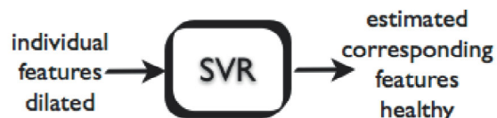
Abb. 2. Die Schritte des vorgestellten Verfahrens. Zunächst werden Ultraschallbilder im gesunden und dilatierten Zustand aufgenommen. Aus diesen Daten werden geometrische Features extrahiert. Anhand dieser Feature-Paare wird ein SVR-Modell trainiert. Mit diesem Modell ist die Schätzung unbekannter gesunder Features möglich.
