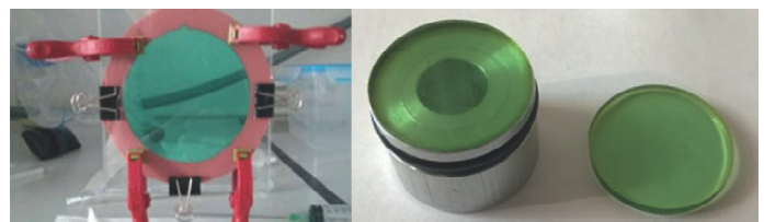
Abbildung 4. Links: Substratträger mit aufgelegter 2 mm Hydrogelmembran und 2mm Hydrogelmembran. Der Durchmesser beträgt jeweils 23 mm, die Dicke jeweils 2 mm. Rechts: Das Monomer-UV-Initiator Gemisch wird wie hier abgebildet in eine Form gegossen und anschließend im 18 W UV-Ofen 60 Min polymerisiert. Am Anschluss muss die Hydrogelplatte 24 Stunden in destilliertem Wasser quellen. Die Stücke, die für Messungen gebraucht werden, können dann ausgestanzt werden.
