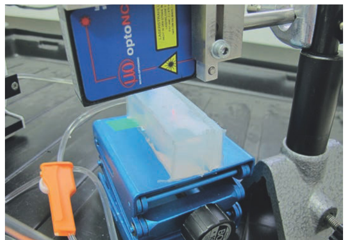
Abbildung 7. Gewebemodell aus Silikon, dargestellt ist auch der Lasertriangulationssensor zur Erfassung der pulsatilen Modellausdehnung
