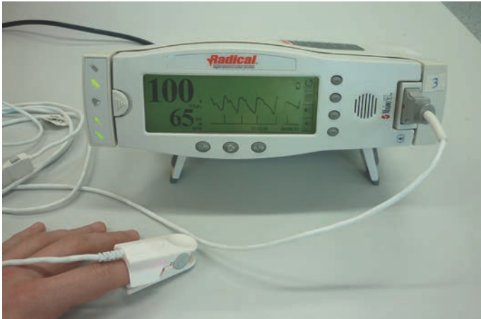
Abbildung 1. Pulsoxymeter im Einsatz am Zeigefinger. Der Monitor zeigt die Herzrate (hier: 65) und die aktuelle Sauerstoffsättigung (hier: 100 %) an
