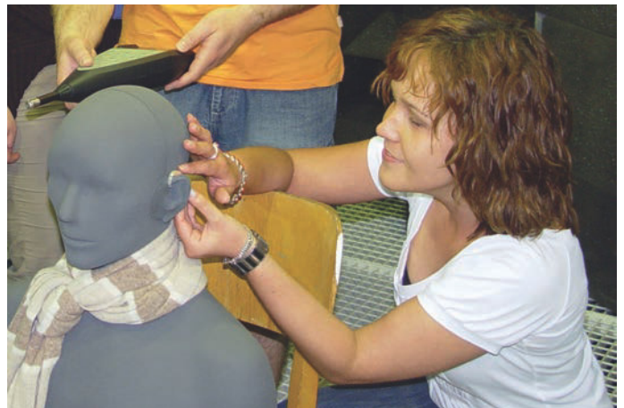
Bild 4: Testen eines Hörgerätes am Kunstkopf
