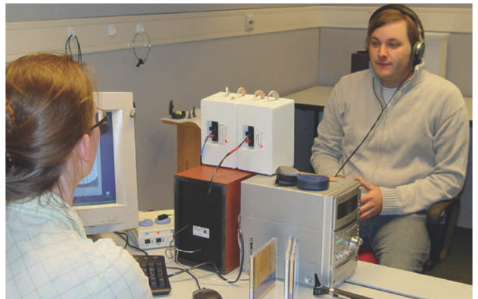
Bild 3. Messung der Sprachverständlichkeit im Anpassraum
