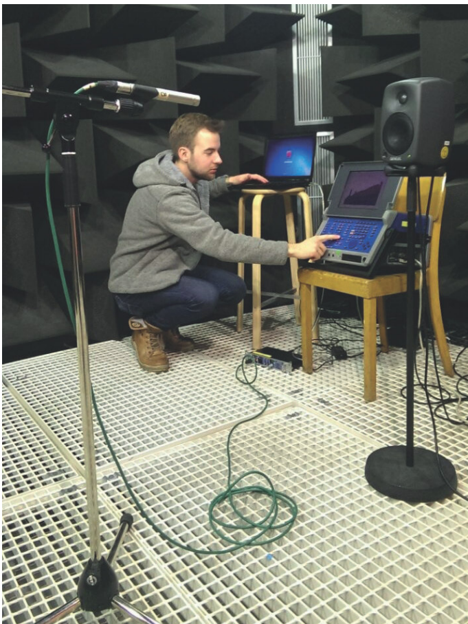
Bild 1. Charakterisierung eines Mikrofons im reflektionsarmen Raum
