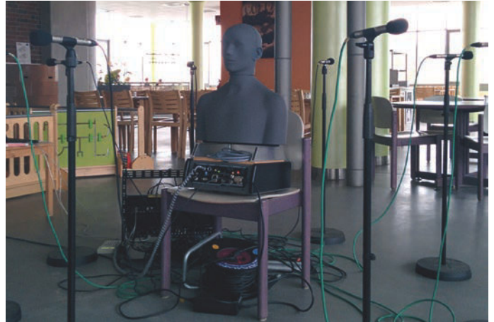
Bild 2. Mehrkanalaufnahmen zur räumlichen Reproduktion von Schallfeldern
