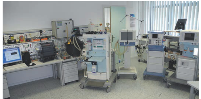
Bild 6. Gasartunabhängige Gasflow- und Ventilationsmessung mit hoher Genauigkeit für Drittmittelprojekte (Foto: U. Wenkebach)
