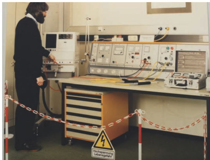
Bild 1. 4000 V Prüfstand für „Elektrische Sicherheit“ im Medizintechnik-Labor 1986 (Foto: Archiv MT Labor)
