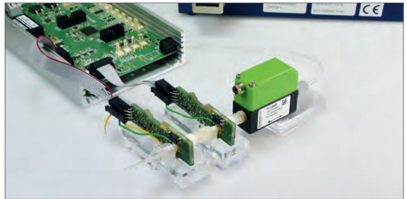
Bild 5: Einwegsensor zur kapazitiven Durchflussmessung in Schläuchen. Vorn: Einwegsensor mit beiden Messstellen und dazwischenliegender Drossel, Rechts: Referenzsensor, Links: Elektronik [10]
