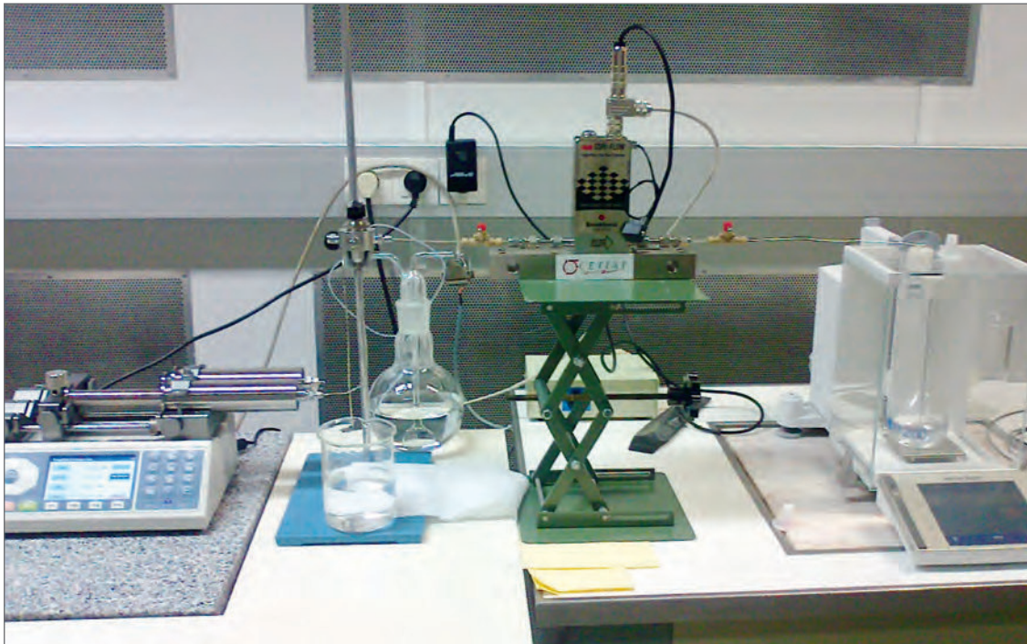
Bild 8: Gravimetrische Prüfung eines Coriolis-Volumen- stromsensors. Links: Präzisions- pumpe, Mitte: zu prüfender Sensor, Rechts: Waage (Bild: Instituto Por- tugues da Qualidade – IPQ, Caparica, Portugal).
